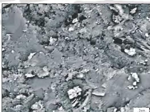
(c) 掺有低温等离子改性橡胶颗粒的水泥石断面
