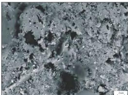
(b) 掺有未改性橡胶颗粒的水泥石断面
